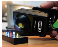
積分球 SPHERE 48 を装着した 単一LED計測(オプション)
